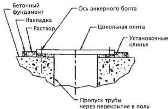
Рис. 6 Установка плиты по уровню
